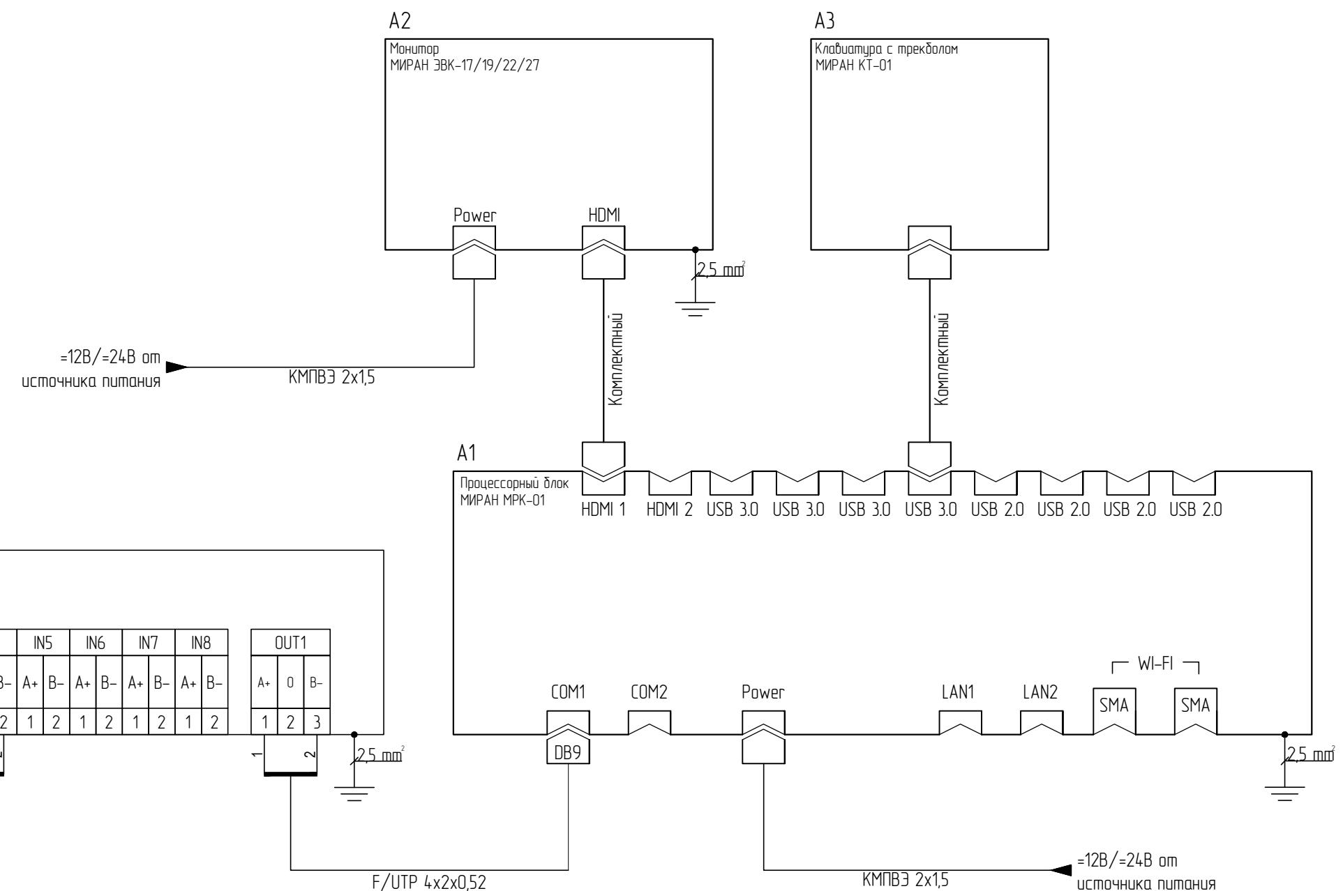
\*На схеме указаны обязательные подключения навигационных приборов к сумматору данных.
